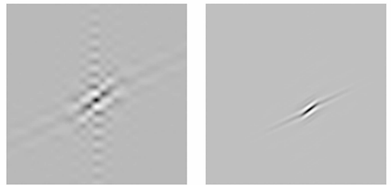
(c)最初的 Contourlet 变换在 (d)SFLCT 在空间域空间域的基图像 空间域的基图像 (c) Basis image of original (d)Basis image of Contourlet in spatial SFLCT in spatial domain domain
